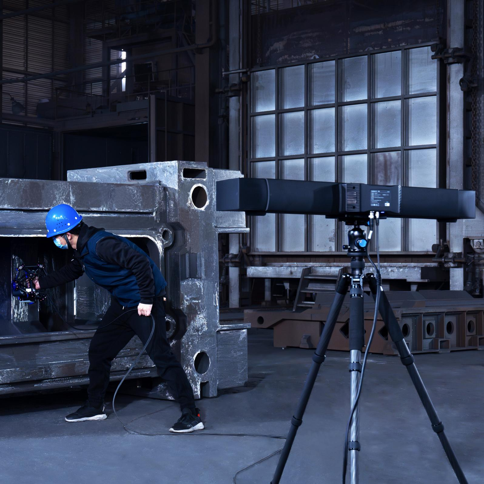
Двухкамерная система слежения
